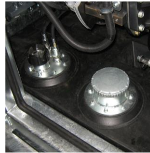
Kraftstofftank Doppelwandiger korrosionsfreier Kraftstofftank (300 Liter) aus HDPE, im unteren Teil des Schallschutzkastens positioniert.
